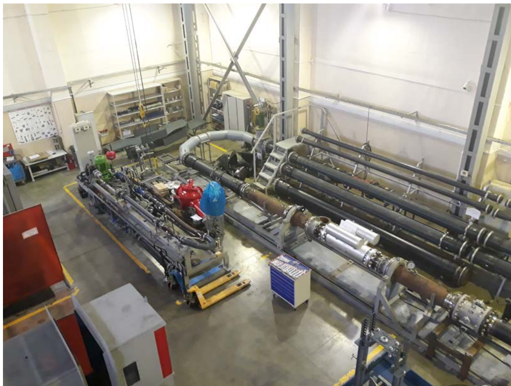
Основные установки газо- и гидродинамических испытаний трубопроводной арматуры в КЦИСС
